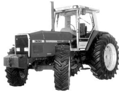
**ZUGLEISTUNG:** max. Leistung 118,3 kW bei 11,8 km/h und Motordrehzahl 2131 min<sup>-1</sup>, dabei 256 g/kWh, bei Nennndrehzahl nicht gemessen
