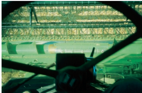
Bild 15: Das Umschwenken der Halmteile von Transport- in Arbeitsstellung erfolgt werkzeuglos.
