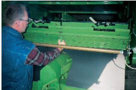
Bild 13: Der Vorbereitungsboden kann durch die nach vorn herausnehmbaren 6 Einschübe problemlos gereinigt werden.
