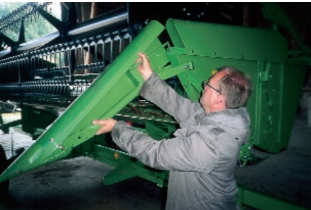
Bild 15: Das Umschwenken der Halmteile von Transport- in Arbeitsstellung erfolgt werkzeuglos.
