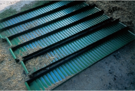
Bild 13: Der Vorbereitungsboden kann durch die nach vorn herausnehmbaren 6 Einschübe problemlos gereinigt werden.
