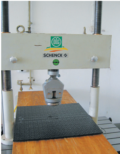
Bild 2: Messung der Eindringtiefe mit Kalotte
