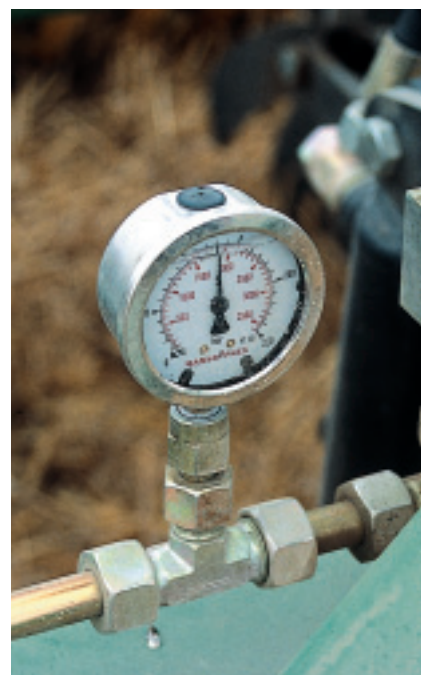
Bild 3: Manometer zur Einstellung der hydraulischen Steinsicherung
