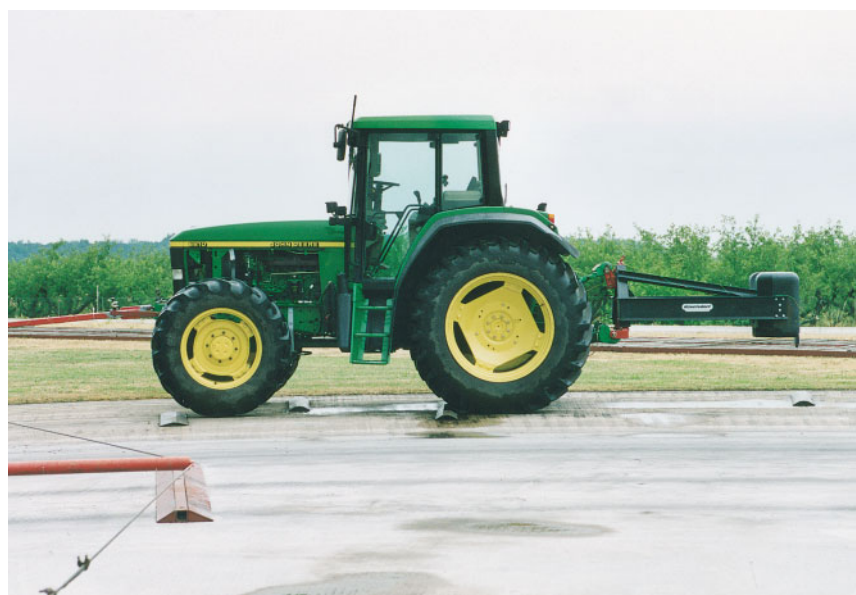
Bild 3: Das Schlepperdreieck mit Ballastträger und Ballast während der Dauerprüfung.
