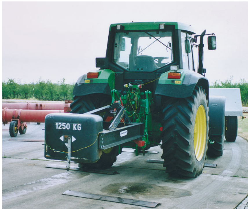
Bild 2: Das an den Testschlepper angebaute Schlepperdreieck mit Ballastträger und Ballast während der Dauerprüfung.
