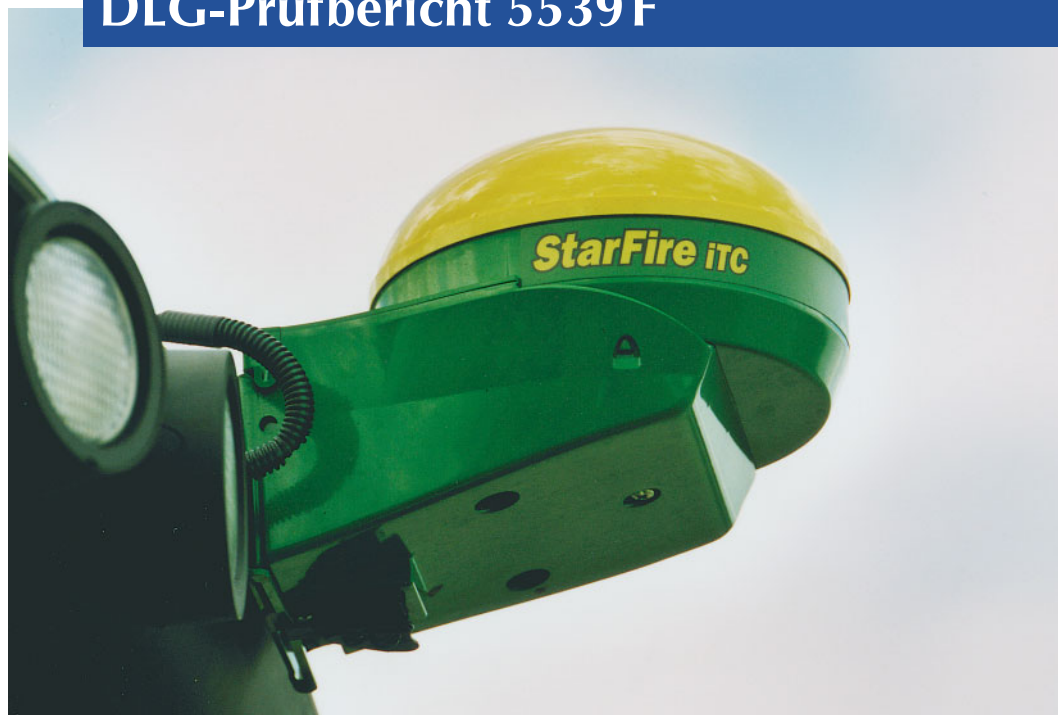
Bild 1: DGPS-Antenne mit integriertem Neigungsaus- gleich
