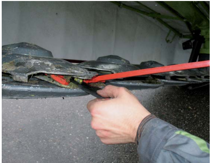
Bild 9: Das DISCO 3500 Contour ist serienmäßig mit einem Schnellwechsel-System für Mähklingen ausgestattet. Der Montagehebel des Mähwerks wird zwischen Mähscheibe und Mähklingshalter eingeführt. Durch Drücken des Montagehebels nach unten wird die Mähklinge frei und kann ausgetauscht werden.
