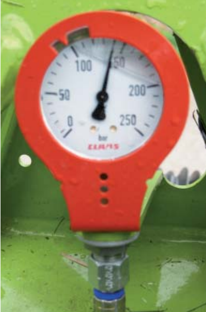
Bild 6: Der Entlastungsdruck wird auf einem Manometer am Anbaublock des Mähwerks angezeigt, welches vom Fahrersitz aus einzusehen ist. Dazu ist eine Drehung des Fahrers um 180 ° erforderlich. Der rote Rand zeigt den empfohlenen Einstellungsbereich.
