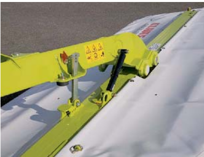
Bild 8: Über das Hubwerk des Traktors wird der Mähbalken so ausgerichtet, dass die Spitze des roten Pfeilbleches und die Aussparung am gegenüberliegenden Flacheisen auf einer Höhe positioniert sind. Diese sind von der Kabine aus sichtbar.
