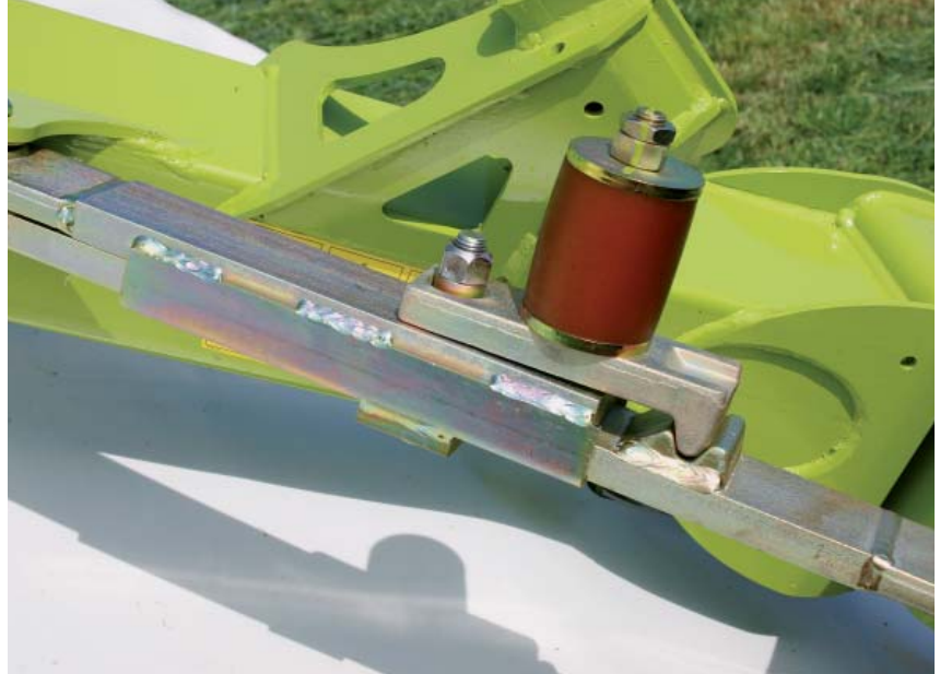
Bild 7: Beim Auffahren auf ein Hindernis löst die Auffahrsicherung aus und der Mähbalken schwenkt nach hinten und nach oben. Durch ein kurzes ruckartiges Zurücksetzen des Traktors wird sie wieder in die Ausgangsposition gebracht und verriegelt.
