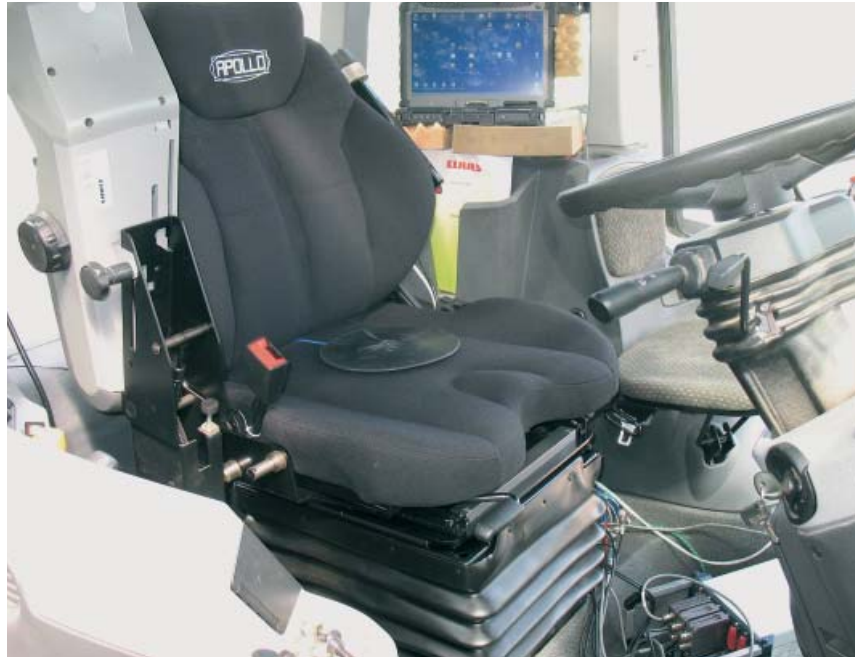
Bild 4: Apollo Sitz im Schlepper mit Messausrüstung
