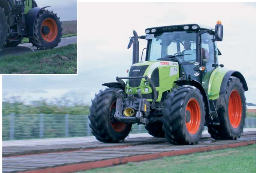
Bild 3: Testschlepper auf Prüfbahn nach EWG78/764/EWG
