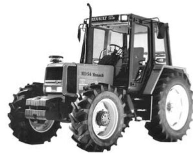
**ZUGLEISTUNG:** bei Nenn Drehzahl 57,7 kW bei 7,2 km/h, dabei 286 g/kWh
