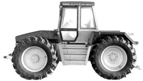
**ZUGLEISTUNG:** max. 107,2 kW bei 8,9 km/h und Motordrehzahl 2000 min<sup>-1</sup>, dabei 266 g/kWh, bei Nenn Drehzahl nicht gemessen
