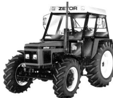
**ZUGLEISTUNG:** bei Nenndrehzahl 47,9 kW und 15,1 km/h, dabei 297 g/kWh
